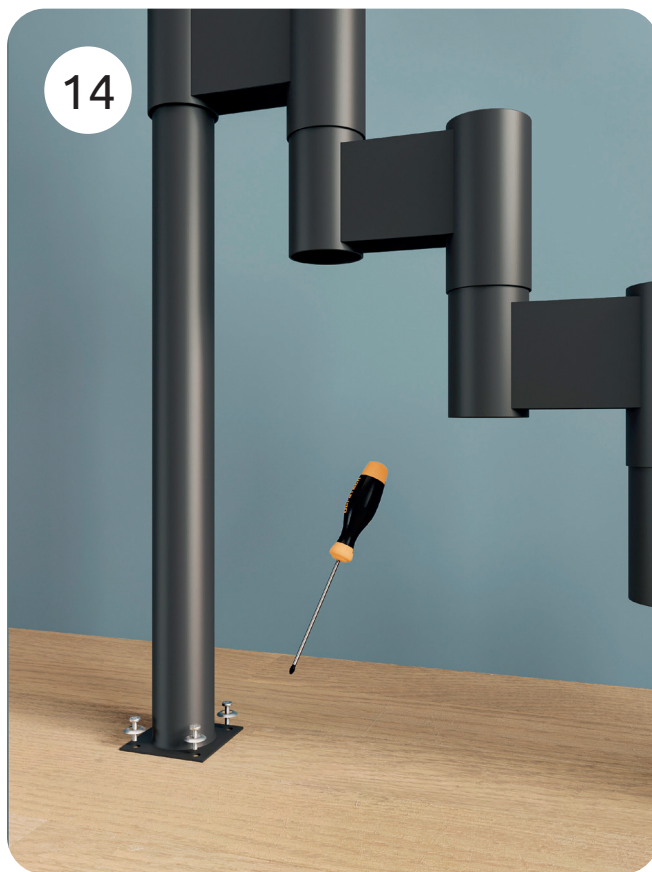
14. Фиксируем опоры к полу.
