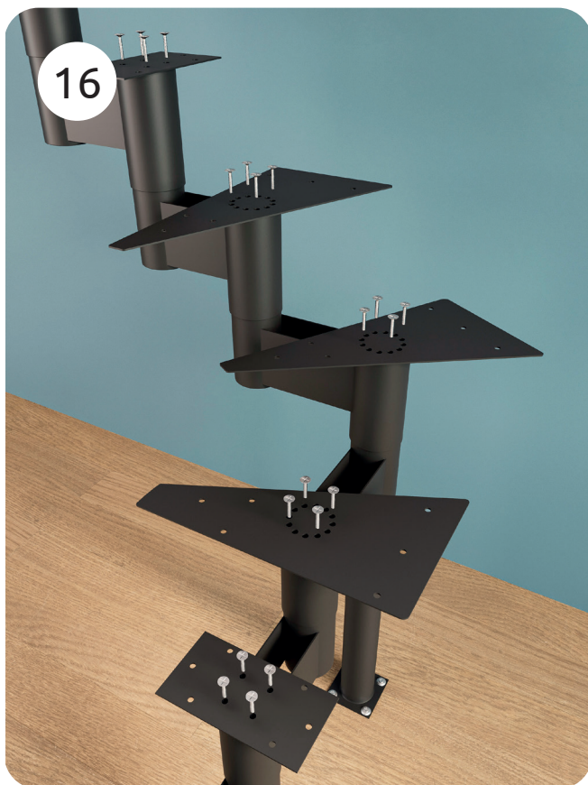
16. Фиксируем фланцы под ступень на 4 винта потай.
