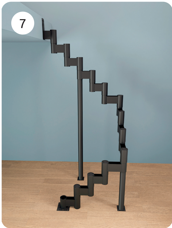
7. Ставим опору 1 м под выдвинутые модули, крепеж в торец насквозь саморезами 2-3 шт.
